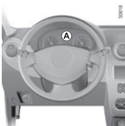
Сигнальные лампы на щитке приборов А
