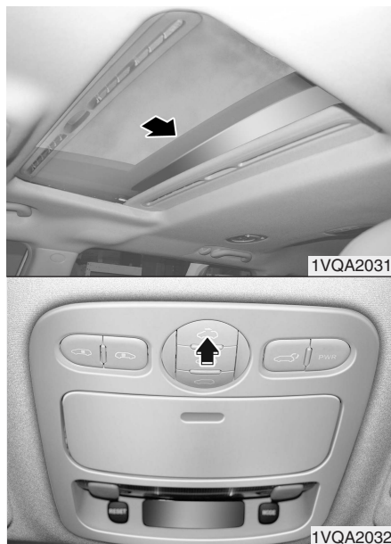
Deslizamiento del techo solar
