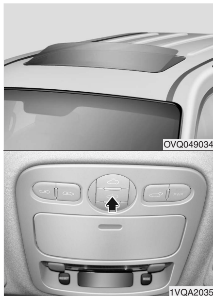
Inclinación del techo solar
