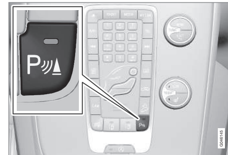
Til-/fra for sensorerne til Parkeringshjælp og CTA 37 .
