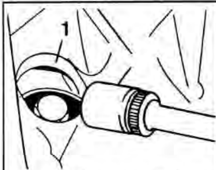
Рис. 7-5. Отвертывание болтов крепления гидротрансформатора крутящего момента к ведущему фланцу с помощью ключа BMW 24 1110:
