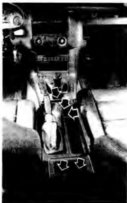
Рис. 16-1. Стрелками показаны винты крепления задней части центральной консоли
