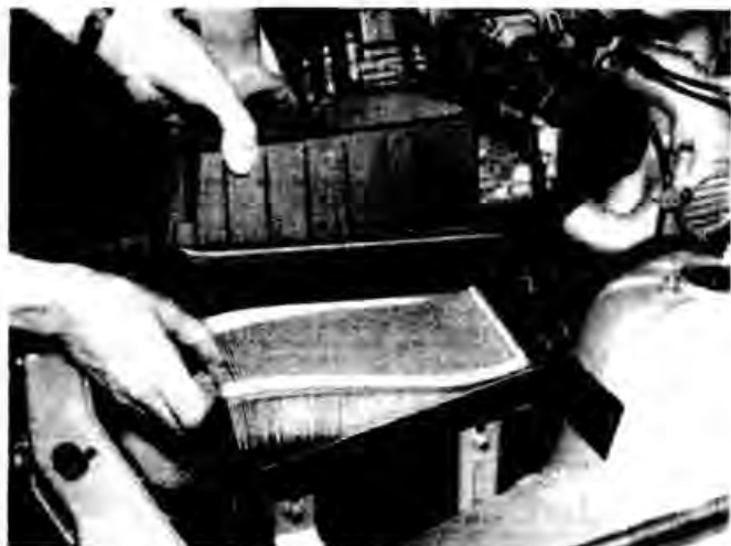
Рис. I-11. Замена фильтрующего элемента воздушного фильтра
