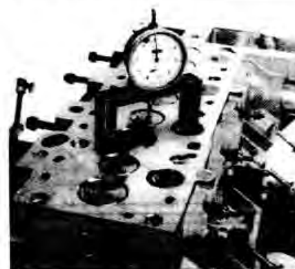
Рис. 3-41. Проверка утопания головки клапана относительно плоскости головки цилиндров
