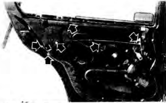
Рис. 15-21. Стрелками показаны винты крепления замка и привода замка задней двери
