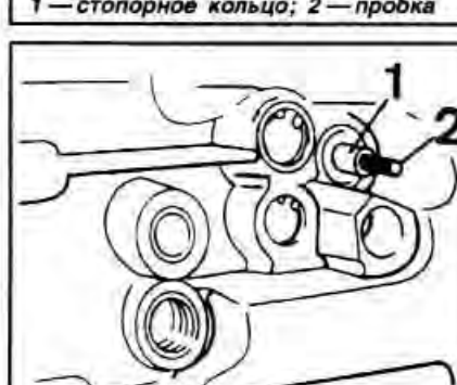
Рис. 5-8. Снятие фиксатора штока выбора передач 1 — пружина; 2 — фиксатор
