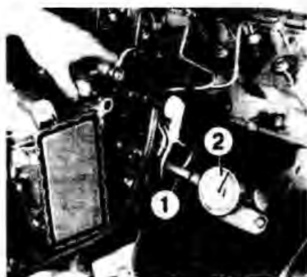
Рис. 3-13. Регулировка угла опережения впрыска топлива ТНВД:
