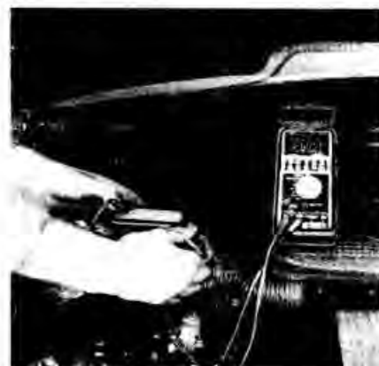
Рис. 3-25. Выполнение проверок на выводах разъема ЗБУ
