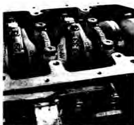
Рис. 3-50. Метки подбора шатунов по поршням
