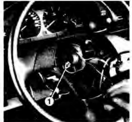
Рис. 12-4. Снятие рулевого колеса: 1 — пружина кольцевого выключателя
