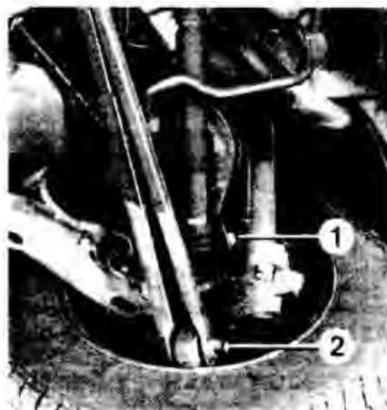
Рис. 11-2. Болты крепления верхнего (1) и нижнего (2) поперечных рычагов подвески к кронштейну ступицы
