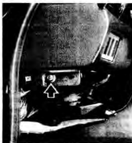
Рис. 16-11. Стрелкой показан болт крепления панели приборов автомобилей с дизельным двигателем и кузовом хэтчбек
