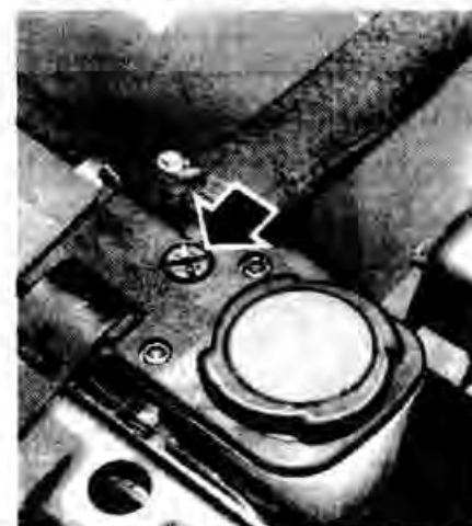
Рис. 1-68. Стрелкой показана пробка отверстия для удаления воздуха из системы охлаждения на радиаторе
