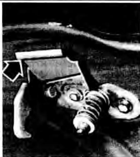
Рис. 1-5. Страховочный крючок замка капота. Для открытия крючка нажать на рычажок в направлении стрелки
