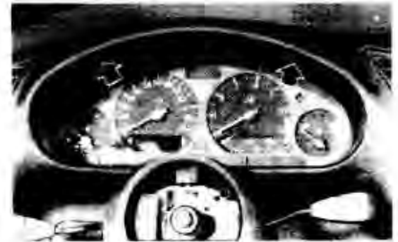
Рис. 14-15. Стрелками показаны винты крепления комбинации приборов
