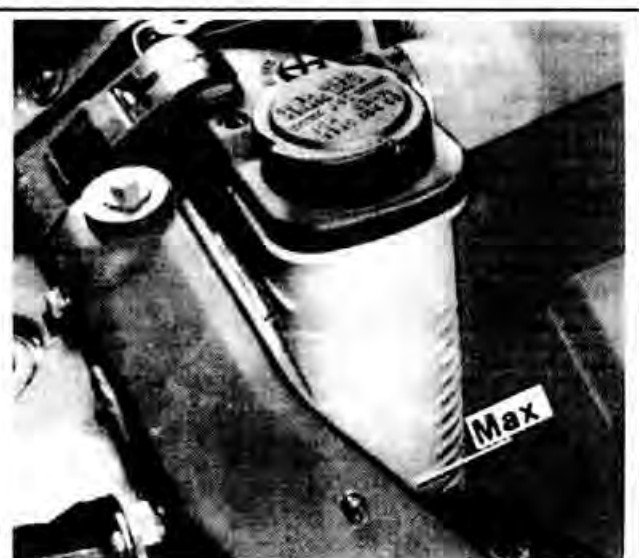
Рис. 1-10. Метка уровня на расширительном бачке системы охлаждения
