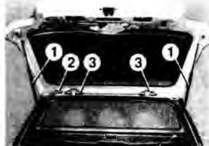
Рис. 15-24. Снятие двери задка:
