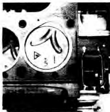
Рис. 3-49. При установке поршня в цилиндр стрелка на днище поршня должна быть направлена в сторону привода распределительного вала
