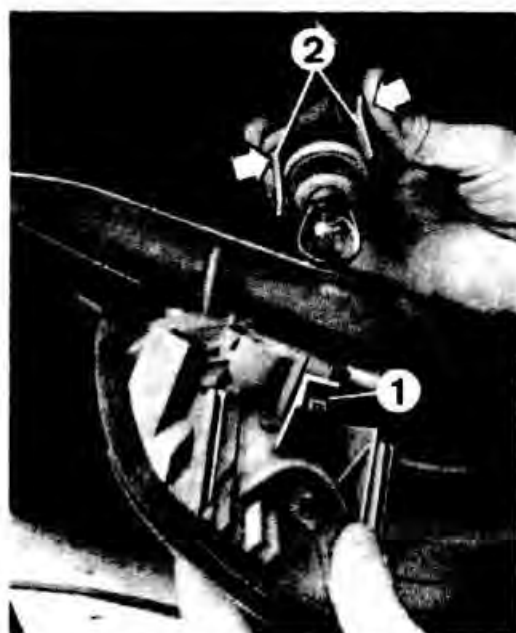
Рис. 1-35. Замена лампы передних указателей поворота: А — снятие корпуса указателя поворота; Б — снятие держателя лампы
