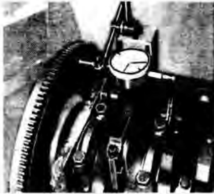
Рис. 2-37. Проверка осевого зазора коленчатого вала
