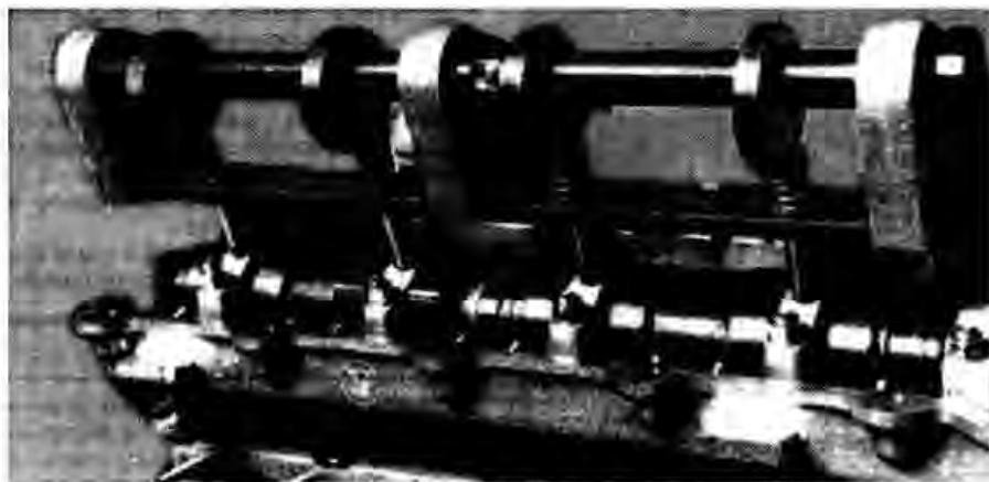
Рис. 1-54. Приспособление BMW 11 32 60 для снятия и установки распределительных валов
