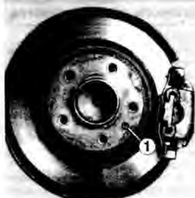
Рис. 13-9. Болт 1 крепления тормозного диска заднего колеса
