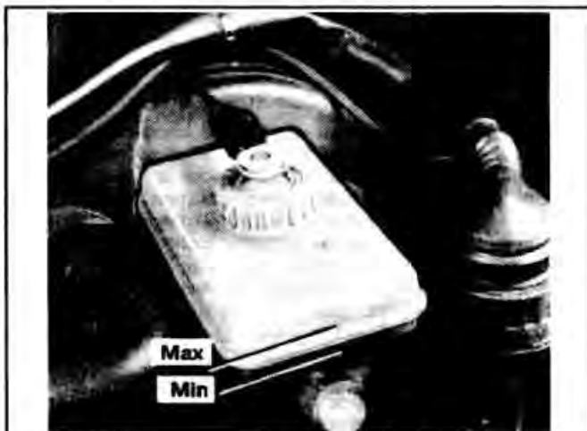
Рис. 1-17. Метки уровня жидкости в бачке тормозной системы
