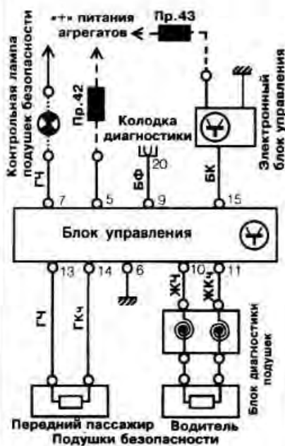
Принципиальная электрическая схема надувных подушек безопасности
