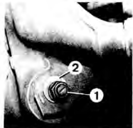
Рис. 11-5. Регулировка развала задних колес:
