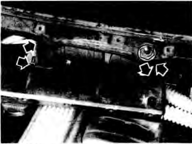
Рис. 16-12. Стрелками показаны болты крепления вентилятора отопителя
