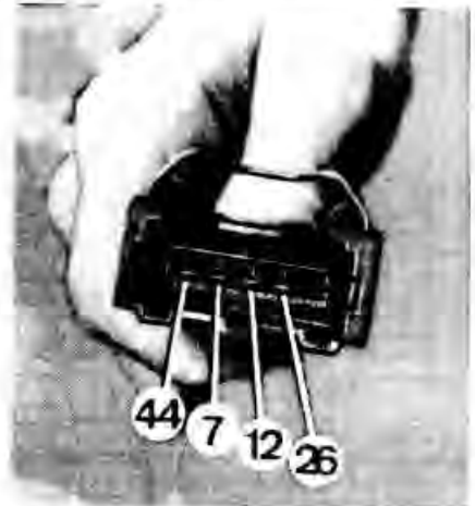
Рис. 1-30. Нумерация штекеров в разъеме измерителя расхода воздуха:
