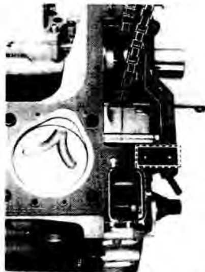
Рис. 3-34. В рамке показана метка толщины прокладки головки цилиндров
