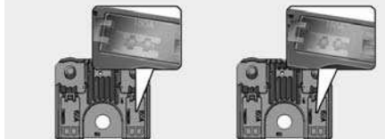
Исправный предохранитель Сгоревший предохранитель
