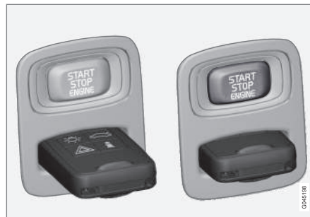
Zündschloss mit herausgezogenem/eingedrücktem Transponderschlüssel.
