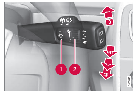
Wisch- und Waschanlage Windschutzscheibe.
