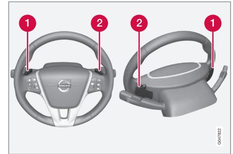
Die beiden "Schaltwippen" des Lenkrads.
