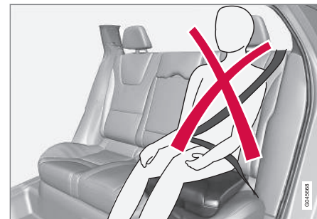
Falsche Position, der Gurt darf nicht unterhalb der Schulter verlaufen.
