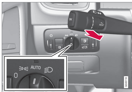
Lenkradhebel und Lichtschalter-Drehregler in Stellung AUTO .
