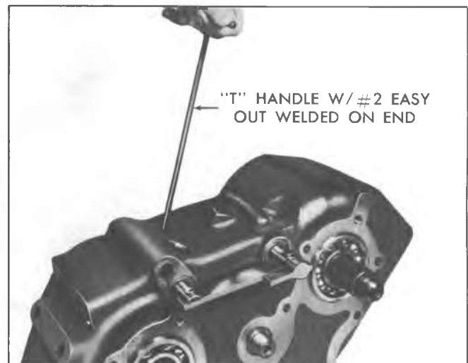
Fig. 7B-6R--Removing Shift Fork Pins
