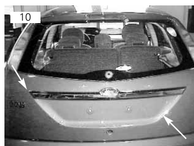
Moldura de proteção da placa vai fixada por meio de cinco porcas M6 sextavadas 10mm
