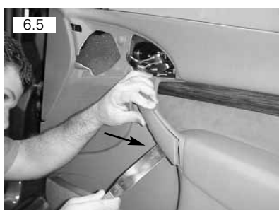
Remover moldura do puxador para ter acesso aos parafusos da forração da porta
