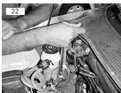
Remover porca M6 sextavada 10 que fixa o cabo massa a carroceria
