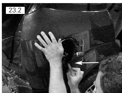
Remover girando no sentido anti-horário e depois no sentido horário com a ajuda da espátula plástica
