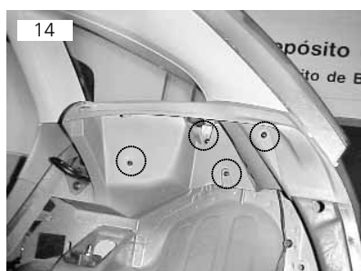
Suporte do porta-pacotes vai fixado por meio de quatro parafusos philips
