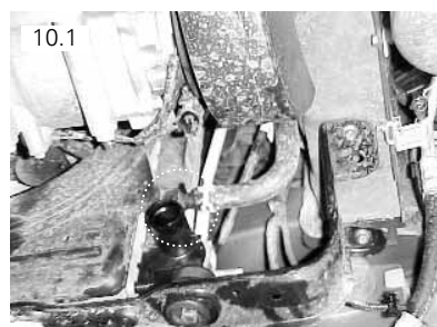
Mangueira do reservatório de expansão se localiza do lado esquerdo na parte inferior e vai fixada por meio de uma braçadeira
