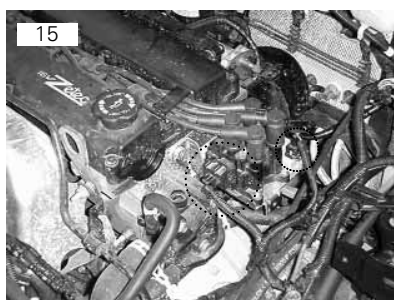
Conexões que se localizam do lado esquerdo
