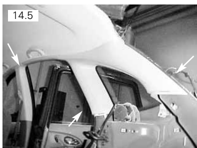
Moldura da coluna C e D vai fixada por meio de presilhas
