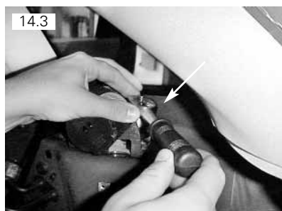
Mecanismo do cinto vai fixado por meio de dois parafusos torx 45. Remover parafuso da parte superior
