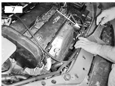
Remover tubulações do radiador. Usar saca-grampo
