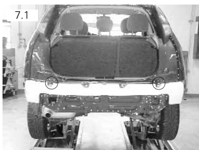
Absorvedor de impactos vai fixado por meio de duas porcas M8 sextavadas 13
