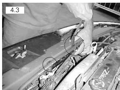
Remover presilhas que fixam o chicote ao painel dianteiro. Usar saca-grampo
