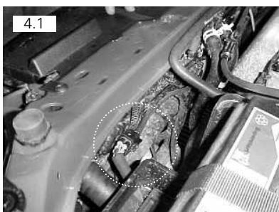
Conexão do eletroventilador se localiza junto ao painel dianteiro do lado esquerdo
