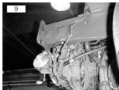
Parafuso M6 sextavado 10mm da travessa do radiador
