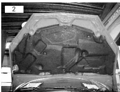
Forração do capô vai fixada por meio de presilhas
