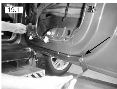
Remover guarnição inferior. Usara saca-grampo para remover as presilhas
