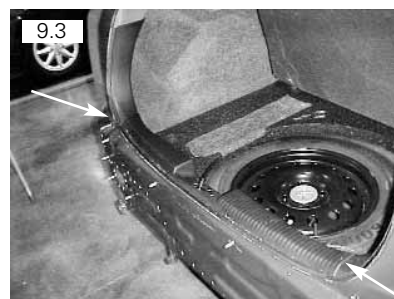
Moldura do painel traseiro vai fixado por meio de seis parafusos philips
