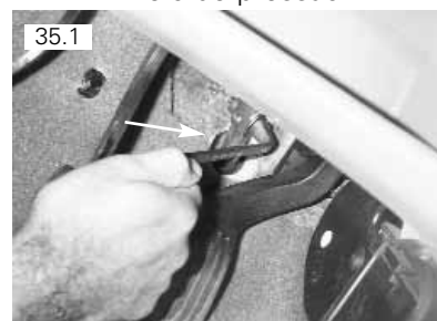
35.1 Remover parafuso. Uma vez removido este parafuso, não gire o volante para nenhum dos lados, pois, do contrário, você irá danificar o contato rotativo da bolsa de air-bag
