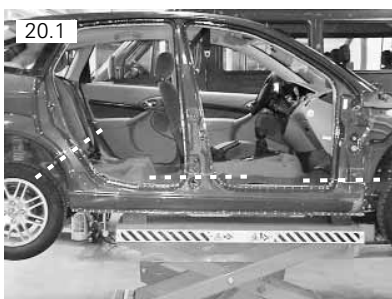
Soleira vai fixada por meio de pontos de solda por resistência. Corte na linha tracejada para fazer sua remoção completa
