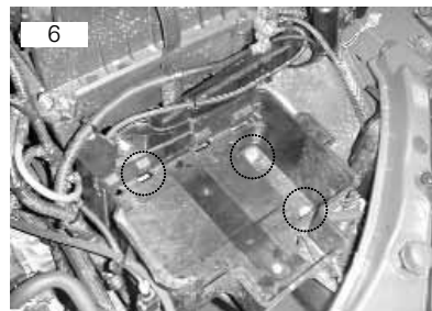
Caixa da bateria vai fixada por meio de três parafusos M8 sextavados 13mm
