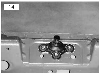
Trinco do porta-malas vai fixado por meio de três parafusos torx 30
