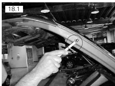
Remover pino M8 sextavado 13mm do amortecedor
