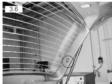
Moldura lateral do porta-malas vai fixada por meio de um pino e por presilhas, cada uma
