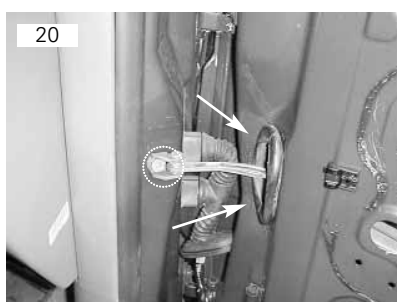
Limitador vai fixado por meio de um parafuso torx 45 e duas porcas M8 sextavadas 13
