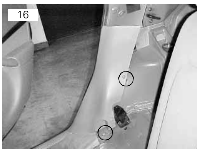
Moldura da caixa-de-rodas vai fixado por meio de dois parafusos philips
