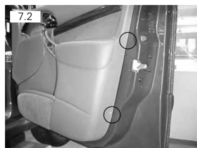
Parafusos se localizam no lado direito
