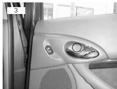
Moldura da maçaneta vai fixada por meio de um parafuso philips e por meio de presilhas
