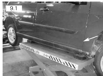
Moldura da soleira vai fixada por meio de sete parafusos torx 30
