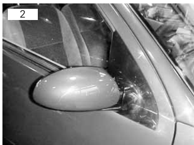
Retrovisor vai fixado por meio de um parafuso atrás da moldura interna do mesmo
