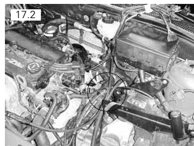
Conector mestre: sonda lambda, sensor de rotação e sensor da pressão da direção hidráulica
