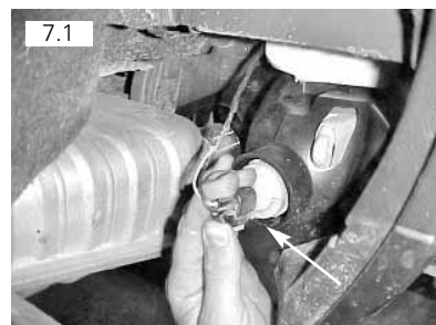
Desconectar luz de neblina que se localiza no lado esquerdo
