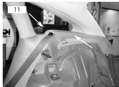
Tampa do mecanismo do cinto vai fixado por meio de presilhas e um parafuso philips
