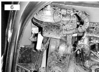
Conexões da buzina se localizam no lado esquerdo na parte inferior
