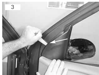
Remover moldura do retrovisor que vai fixada por meio de presilhas. Usar espátula plástica
