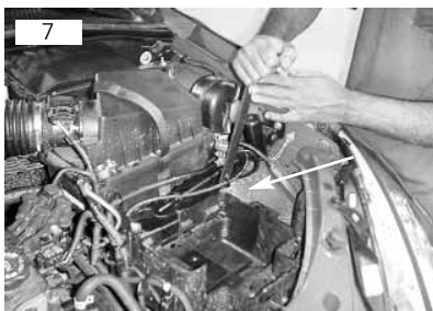
Remover presilhas que fixam o chicote junto à caixa. Usar saca-grampo
