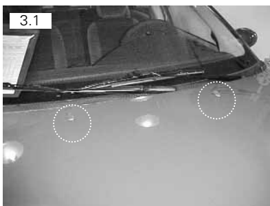
Esguichos vão fixados por meio de encaixe
