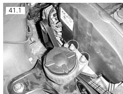
Coxim hidráulico vai fixado por meio de duas porcas M10 sextavadas 18mm
