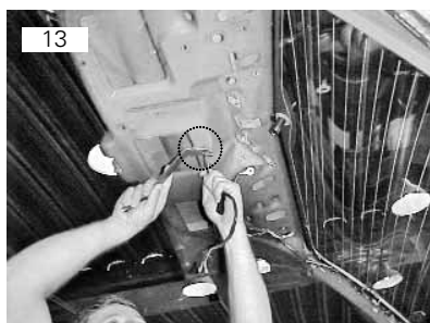
Chicote vai fixado por meio de presilhas. Remover chicote usando saca-grampo
