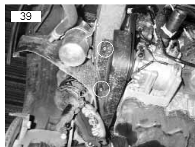
Proteção das polias vai fixada por meio de dois parafusos M6 sextavados 8mm
