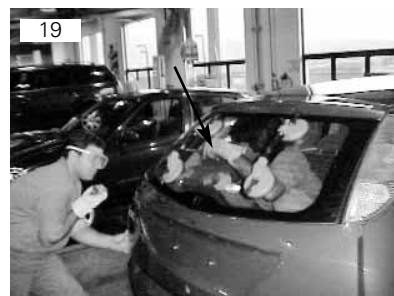
O vidro do vigia vai colado junto à tampa. Para removê-lo faça pelo método de arame
