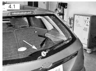
Limpador do vigia vai fixado por meio de uma porca M8 sextavada 13mm
