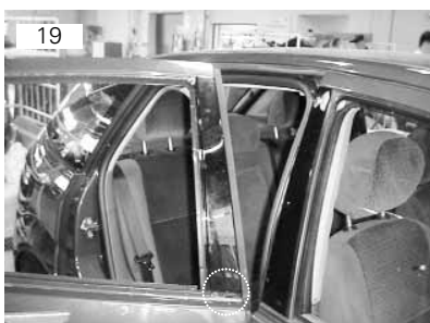
Moldura de acabamento do quadro da porta vai fixado por meio de um rebite
