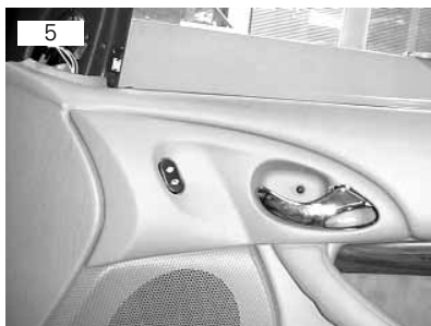
Moldura da maçaneta vai fixada por meio de um parafuso philips
