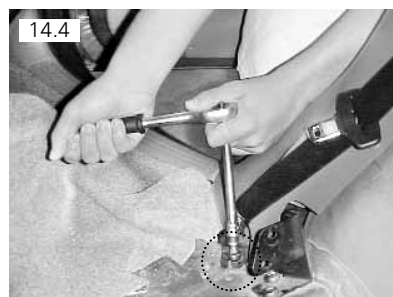
Remover parafuso que se localiza na parte inferior
