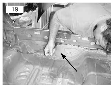
Chicote vai fixado no painel traseiro por meio de presilhas. Remover presilhas com saca-grampo
