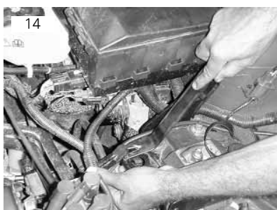
Remover pino que fixa o chicote que se localiza no suporte do coxim do câmbio
