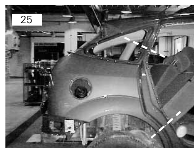
Lateral traseira vai fixada por meio de pontos de solda por resistência. Corte-a na linha tracejada para fazer uma substituição parcial
