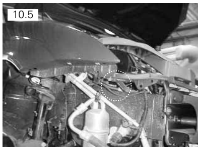
Parafuso se localiza unido ao painel dianteiro
