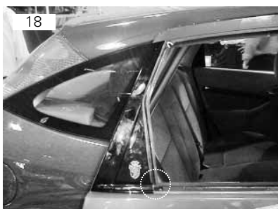
Moldura de acabamento externo da porta vai fixado por meio de um rebite
