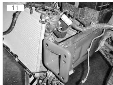
A extensão da longarina vai fixada por meio de solda Mig. Corte na linha tracejada para removê-la
