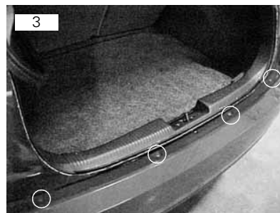
Parafusos philips que se localizam na parte superior
