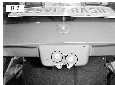
Fechadura da tampa do porta-malas vai fixada por meio de dois parafusos torx 30
