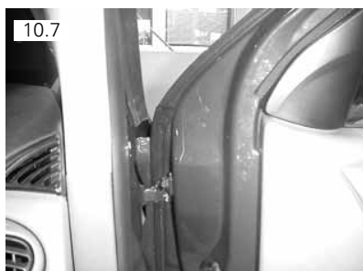
Parafuso se localiza na coluna A, atrás da porta dianteira
