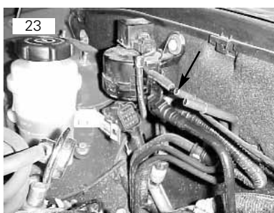
Tubulação do cânister ao coletor
