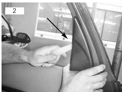
Moldura de acabamento interno da porta vai fixada por meio de presilhas. Remover usando espátula plástica
