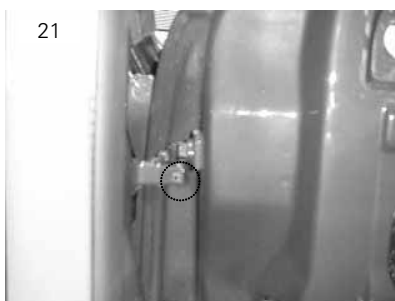
Dobradiças Vão fixadas por meio de um parafuso torx M6
