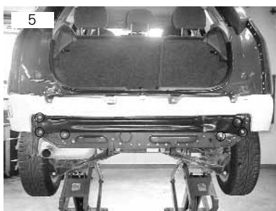
Traveza do painel traseiro vai fixada por meio de seis porcas M8 sextavadas 13
