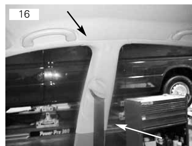
Moldura superior da coluna B vai fixada por meio de presilhas
