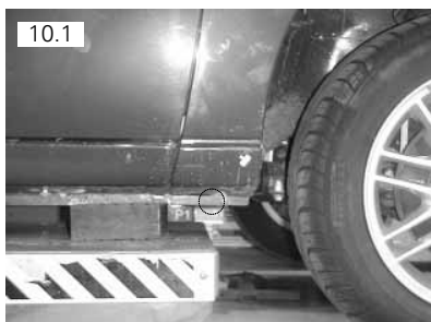
Parafuso se localiza atrás da moldura da soleira
