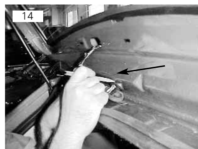
Remover molduras do chicote junto à tampa traseira
