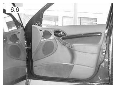
Forração da porta vai fixada por meio de oito parafusos philips
