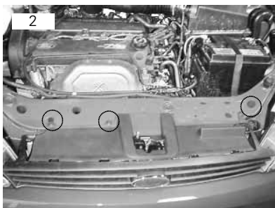
Defletor de ar do capô vai fixada por meio de três parafusos philips
