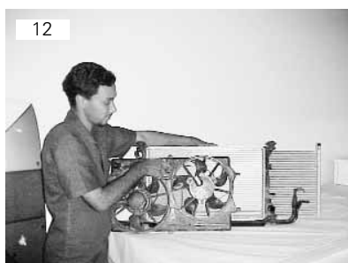
O conjunto vai apoiado na travessa e é fixado por meio de travas
