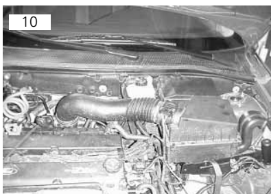
Filtro de ar vai apoiado em três coxins e é fixado por meio de uma braçadeira
