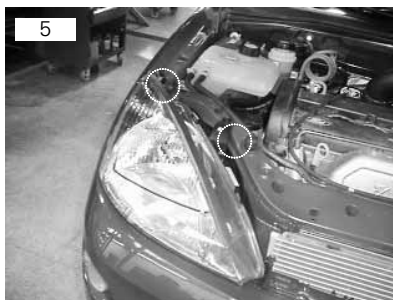
Conjunto ótico vai fixado por meio de três parafusos de rosca soberba sextavados 10 mm, sendo dois na parte superior
