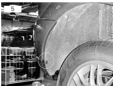
Parafuso torx 30 vai fixado junto ao pára-barro, um de cada lado
