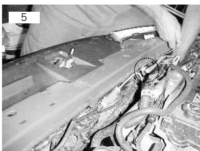
Remover presilhas que fixam o chicote à tela do eletroventilador. Usar saca-grampo
