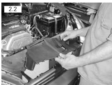
Remover defletor de ar do capô
