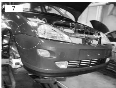
Pára-choque vai fixado por meio de seis parafusos de rosca soberba sextavados 10mm. Esses parafusos se localizam internamente na área mostrada acima
