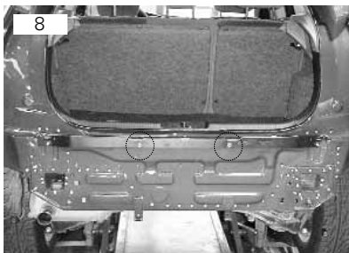
Suporte de sustentação do pára-choque traseiro vai fixado por meio de duas porcas M8 sextavadas 13mm
