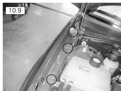
Parafusos se localizam sobre a moldura da caixa-de-rodas
