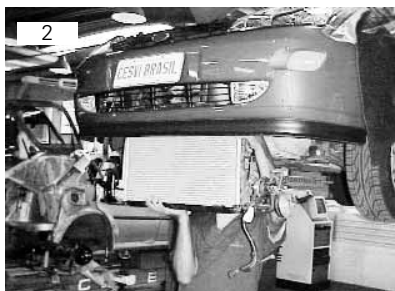
Remover travessa com o conjunto radiador, condensador e eletroventilador
