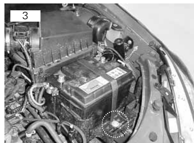
Bateria vai fixada em uma alça por meio de um parafuso M8 sextavado 13mm
