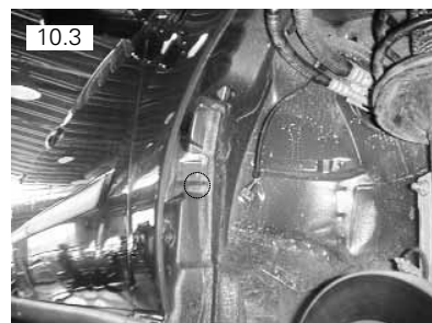
Parafuso se localiza atrás do anti-ruídos
