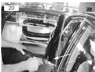
Remover rebite usando furadeira e broca de 3,5 mm
