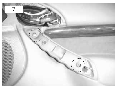
Parafusos se localizam atrás da moldura do puxador
