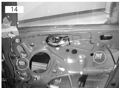
Vidro da porta vai fixado por meio de dois parafusos M6 sextavados 10mm
