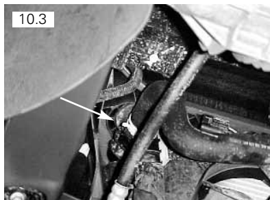
Mangueira do radiador que se localiza do lado esquerdo na parte superior
