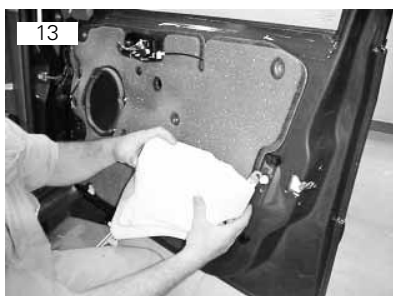
Remover absorvedor de ruídos
