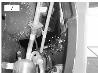
Parafuso se localiza atrás do pára-barro
