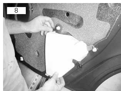
Remover absorvedor de ruídos
