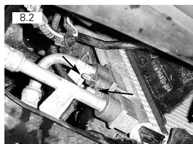
Tubulações do condensador se localizam do lado direito na parte inferior e vão fixados por meio de duas porcas M8 sextavadas 13mm
