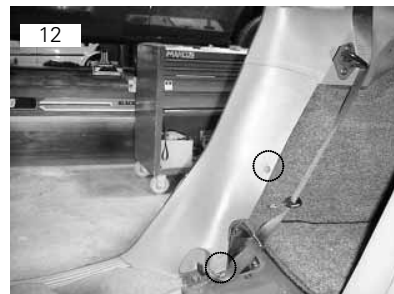
Moldura da caixa-de-rodas vai fixada por meio de dois parafusos philips e presilhas
