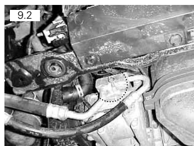
Conexão de alimentação do compressor ao condensador vai fixada por meio de uma porca M6 sextavada 10mm
