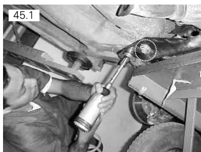
Remover parafusos M12 sextavados 18mm
