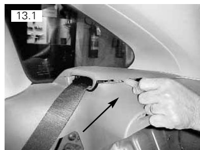
Remover tampa do mecanismo do cinto. Usar espátula plástica
