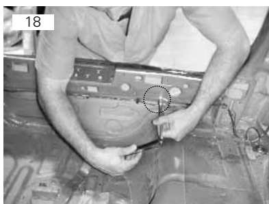
Fio terra vai fixado por meio de um parafuso M6 sextavado 10. Remover parafuso para soltar o fio
