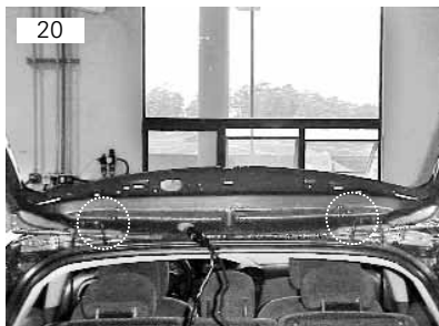
Dobradiças fixam a tampa traseira junto à carroceria por meio de dois parafusos M6 sextavados 10mm
