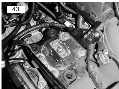
Coxim do câmbio se localiza do lado esquerdo e vai fixado por meio de uma porca M12 sextavada 21mm
