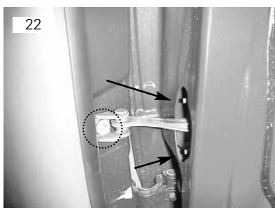
Limitador vai fixado por meio de um parafuso torx 45 e duas porcas M8 sextavadas 13mm
