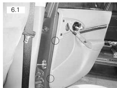
Parafusos se localizam no lado esquerdo
