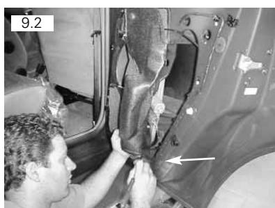
9.2 Membrana da porta vai colada junto à porta. Para removê-la sem danificar, use a espátula de aço
