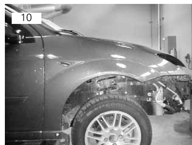
Pára-lama vai fixado por meio de sete parafusos de rosca soberba sextavados 10mm
