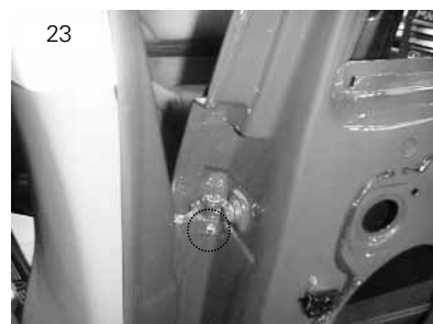
Dobradiças vão fixadas por meio de um parafuso torx M6
