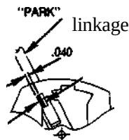
1973-77 Turbo Hydra-Matic shift linkage
