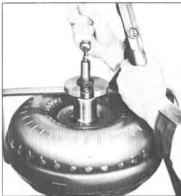
Fig. 7A-138C--Air Checking Converter
