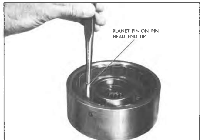
Fig. 7A-132C--Installing Planet Pinion Pin
