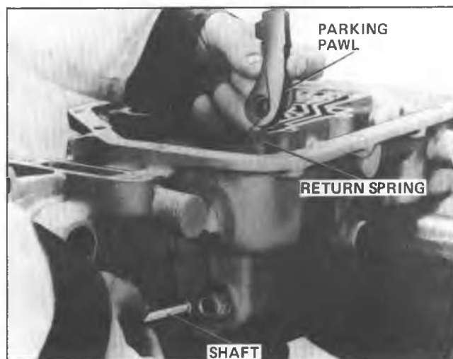
Fig. 7A-54A--Installing Parking Pawl
