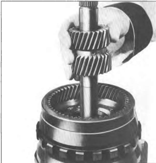
Fig. 7A-49C--Removing Sun Gear
