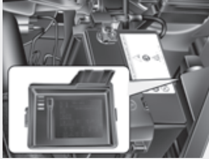
Motor bölmesi sigorta paneli (Sadece projeksiyon ön far tipi)
