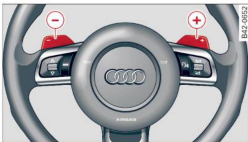
Fig. 64 Steering wheel: shift paddles
