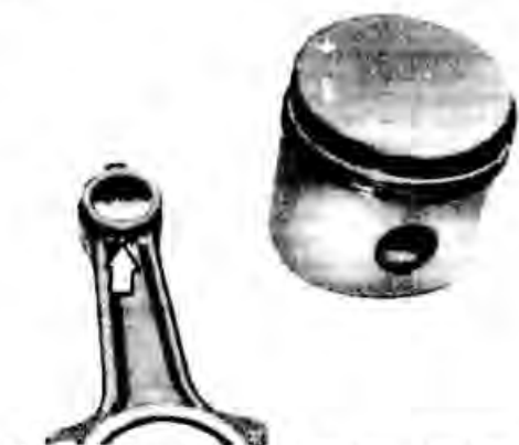
При сопряжении поршня с шатуном смазочное отверстие (показано стрелкой) в верхней головке шатуна должно быть направлено в сторону стрелки для ориентации поршня в цилиндре. Выбитая на днище поршня метка «+» указывает на группу поршня по массе
