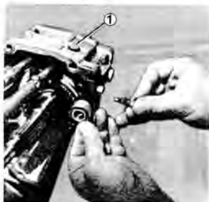
Снятие опоры промежуточной тяги: 1 — болт-ось промежуточного рычага
