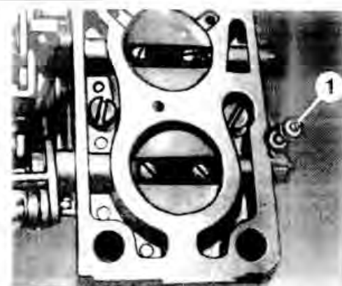
Расположение регулировочного винта 1 дроссельной заслонки 2-й камеры
