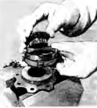
Полуосевая шестерня и нажимная муфта самоблокирующегося дифференциала
