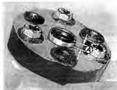
При запрессовке центрирующей втулки необходимо выдержать размер «А» между торцом втулки и поверхностью эластичной муфты, равный 5 мм
