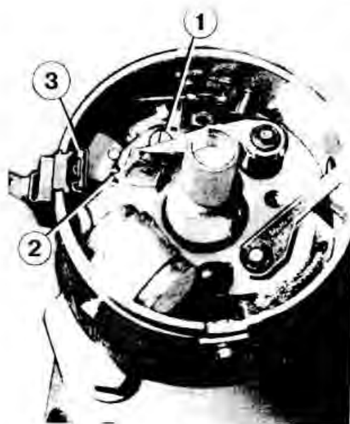
Детали распределителя контактной системы зажигания:
