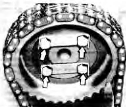
Болты крепления (показаны стрелками) зубчатого шкива привода распределительного вала
