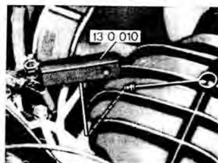
Регулировка содержания CO в отработавших газах
