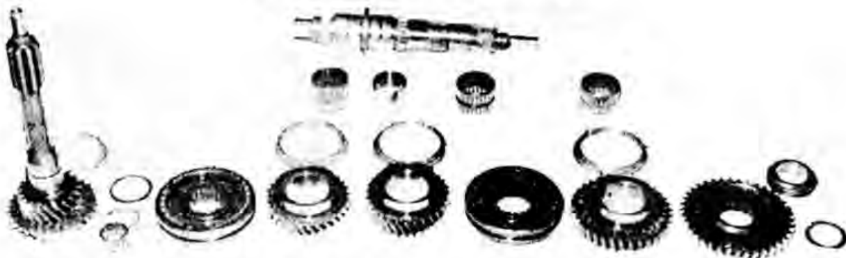
Детали первичного (слева) и вторичного (в центре) валов
