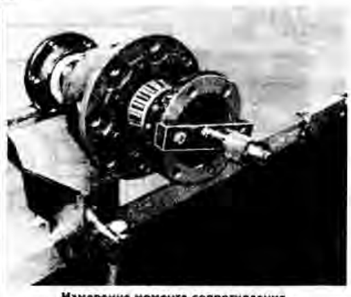
Измерение момента сопротивления проворачиванию подшипников самоблокирующегося дифференциала динамометрическим ключом при зажатом в тисках фланце выходного вала
