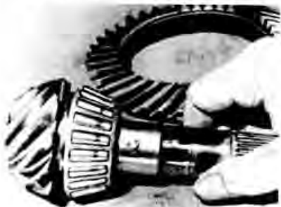
Маркировка отклонения действительного расстояния между торцом ведущей шестерни и осью дифференциала и номинальной величины в сотых долях миллиметра ведущей шестерни
