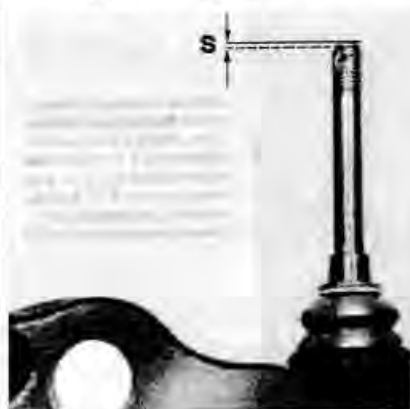
Проверка радиального зазора «S» пальца шарового шарнира рычага подвески
