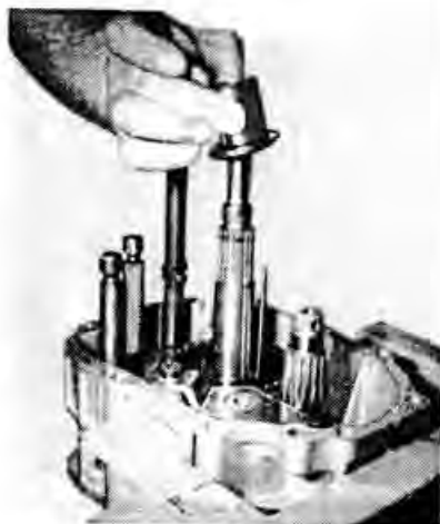
Установка втулки шестерни V передачи. Обратите внимание на положение кон-
