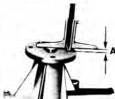
При установке ступицы водяного насоса выдержите размер «А» 3 \pm 0,5 мм
