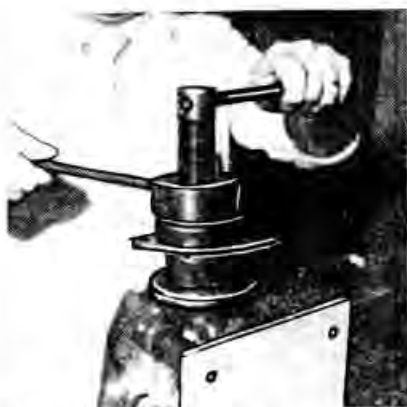
Напрессовка фланца на ведущую шестерню приспособлением 23 1 300
