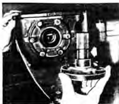
Снятие выходного вала дифференциала. Стрелкой показано место установки запорного кольца
