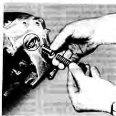
Проверка блокировочного сухаря
