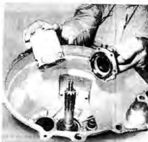
При установке передней крышки нанесите на ее сопрягающуюся поверхность герметик типа Curil K2
