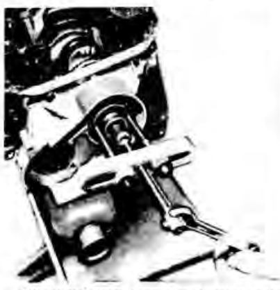
Снятие зубчатого шкива коленчатого вала
