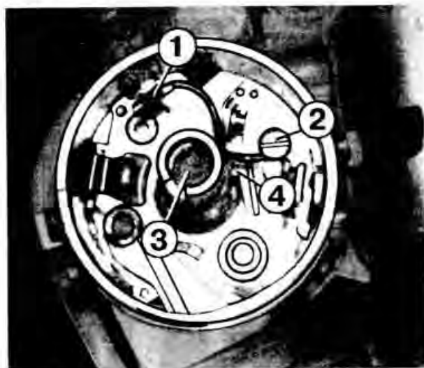
Детали распределителя контактной системы зажигания: 1 — рычажок прерывателя; 2 — стопорный винт пластины неподвижного контакта; 3 — фетровая вставка для смазки кулачка; 4 — контактная пластина рычажка прерывателя
