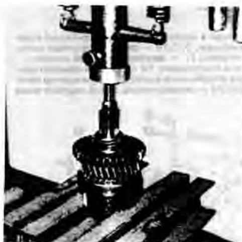
Разборка вторичного вала с помощью пресса
