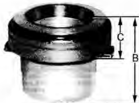
Размеры для проверки высоты подшипника выключения сцепления
