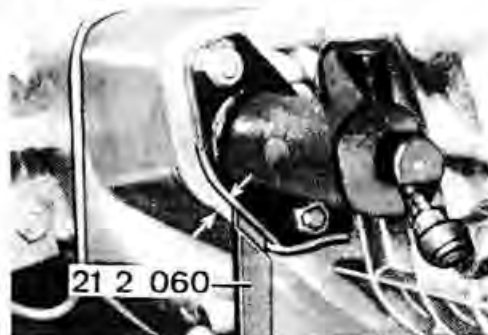
Проверка износа ведомого диска сцепления шаблоном
