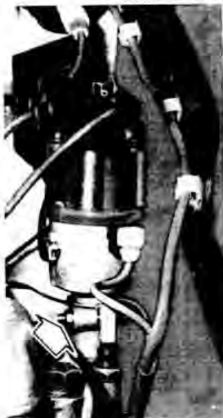
Расположение болта крепления распределителя зажигания
