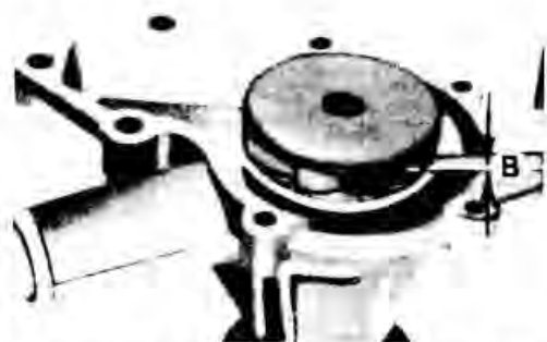
При напрессовке крыльчатки насоса выдержите размер «В» 1 \pm 0,2 мм
