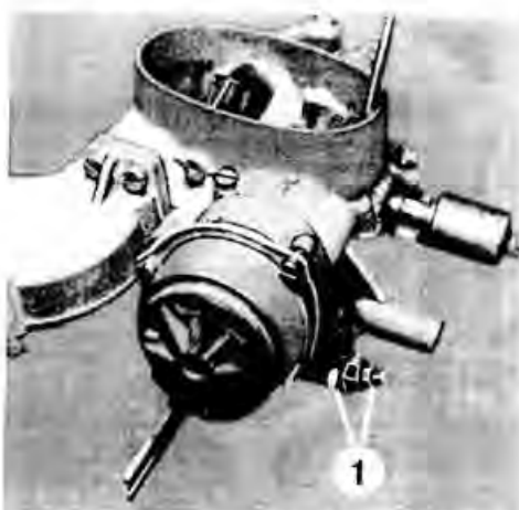
Регулировочные гайки 1 ускоренного холостого хода
