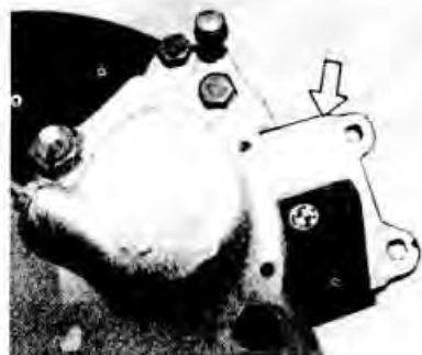
Установка прижимных пластин на тормозном механизме переднего колеса марки Girling
