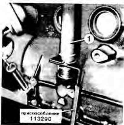
Установка фиксатора 11 1290 компенсационной трубки
